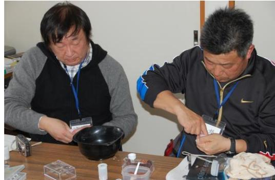
屈斜路火砕流の火山灰を、わんがけ法で見ていく。「わんがけ」とは、火山灰を見る方法である。まず、耳かき2杯分程度のサンプルを弁当のおかず入れ等の小さな容器に入れ、鉤物に付着している混合物を押しつぶして水に溶かし出す気持ちで、親指で押し洗いし、これを繰り返すと洗った後も水が濁らず透明なままになる。次に、残った残渣を濾紙に乗せて水分をとり、ルーペで拡大して見る。今日は最初に火山灰のサンプルと伝えたが、子ども達には伝えずに行う。ルーペで見ると「キラキラ」が見え、これは火成岩であることを子ども
